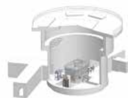
熔融塩実験炉の概念図
